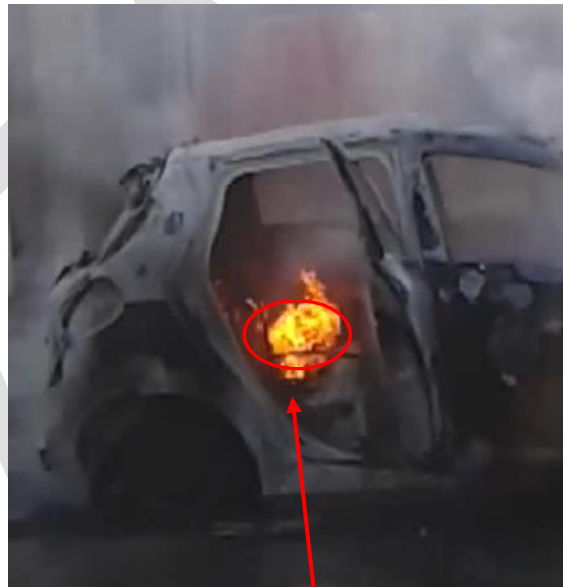
Pacco batterie con coperchio termofusibile (Fire-access),
