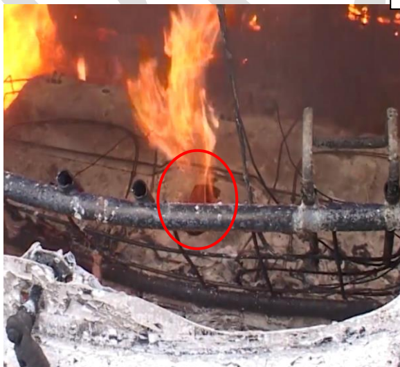
Fire acces, unico punto di accesso, se presente, dove poter “riempire” la batteria di acqua
