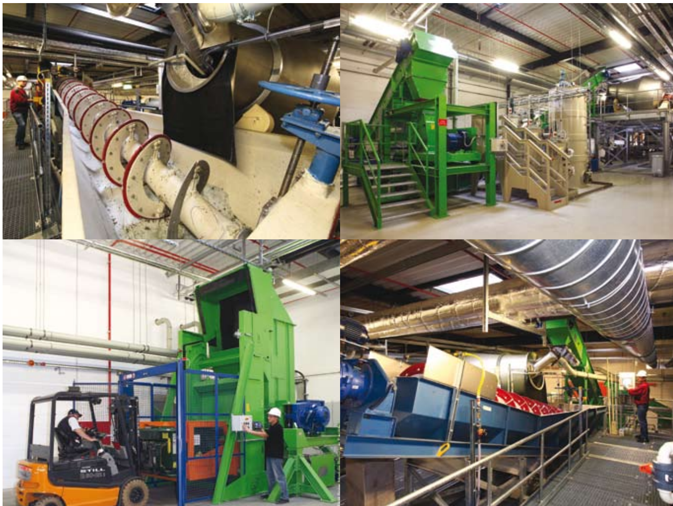
La linea di riciclaggio in First Solar. In alto: a sinistra il vetro viene separato dai liquidi attraverso un apposito processo; a destra una panoramica della linea. In basso: a sinistra il carico dei pannelli all'inizio della lavorazione; a destra una fase della separazione dei materiali.
